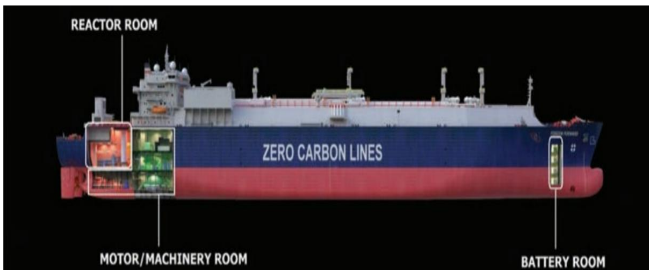
Slika 2. Smještaj prostorije na brodu za prijevoz ukapljenog prirodnog plina na nuklearni pogon
