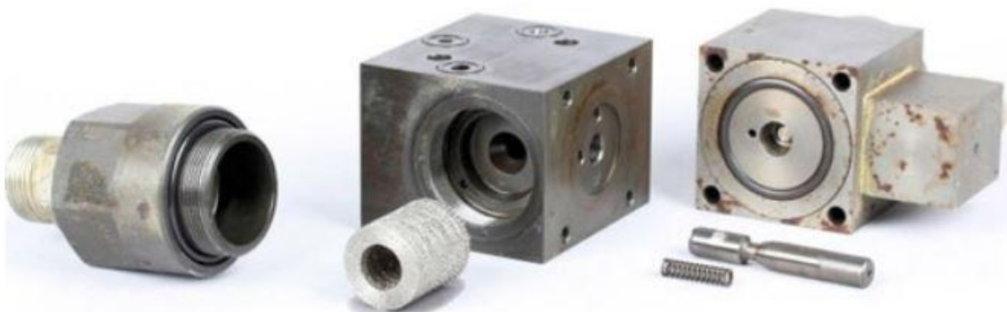
Slika 8. Potpuno rastavljen kontrolni ventil
