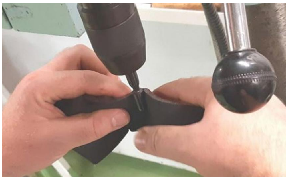
Slika 10. Poliranje kontrolnog klipa
