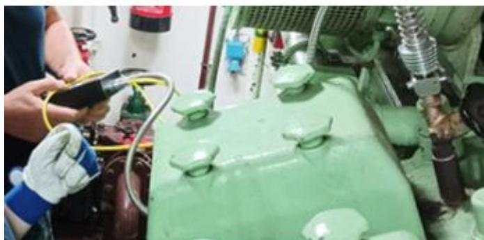
Slika 5.5.2 Mjerenje sa uređajem Maridis MarPrime Ultra na dizel motoru RB&W Alpha Dizel 14V23L-VO
