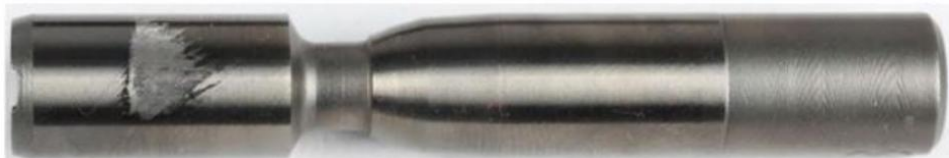
Slika 11. Oštećenja u kontrolnom dijelu koja ne utječu na regulaciju
