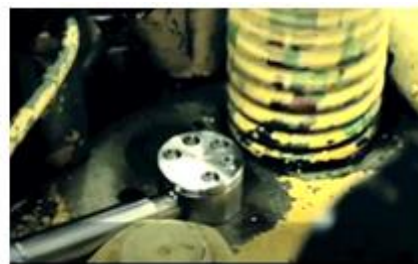
Slika 5.3.2. Ultrazvučni senzor i prikaz postavljenog na poklopcu cilindra motora
