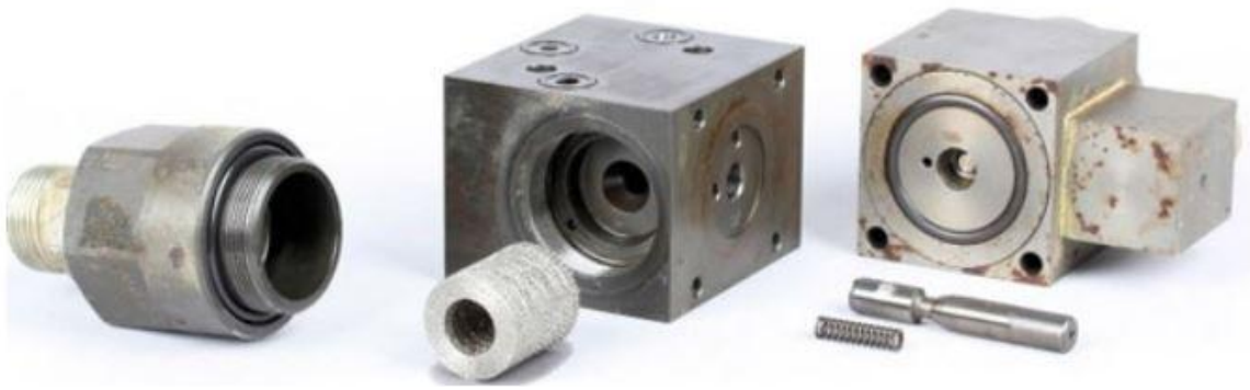
Slika 8. Potpuno rastavljen kontrolni ventil
