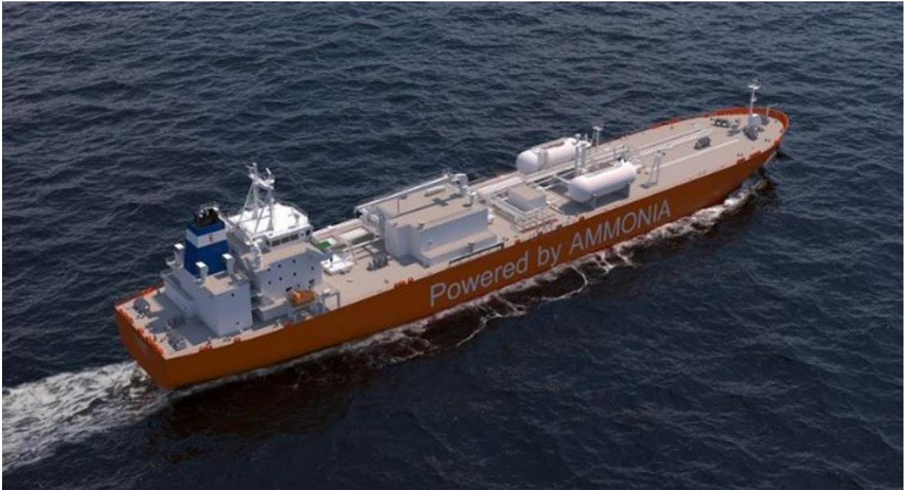
Slika: Brod za ukapljeni naftni plin pogonjen amonijakom
