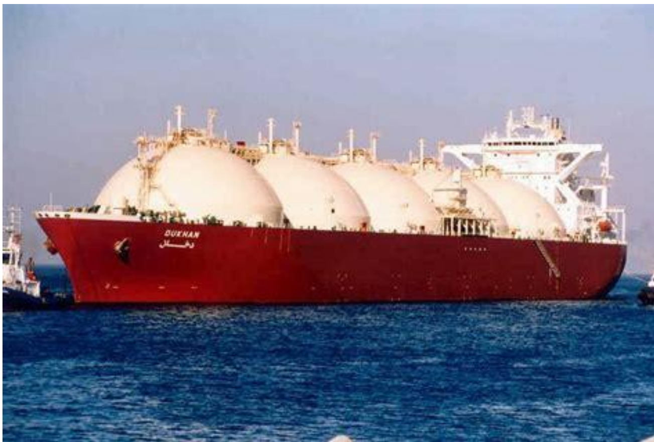
Slika 1. Brod za prijevoz ukapljenog prirodnog plina „Dukhan“
