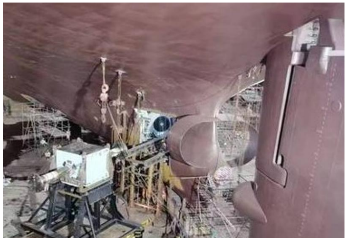
Slika: Osovinski generator ulazi u „Berge Toubkal“ u suhom doku
