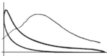
Slika 3.4. Zatvoreni i otvoreni indikatorski dijagram snimljen mehaničkim indikatorom na brodskom dvotaktnom motoru K6SZ 78/155A pri 75% opterećenja
