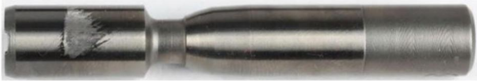
Slika 11. Oštećenja u kontrolnom dijelu koja ne utječu na regulaciju
