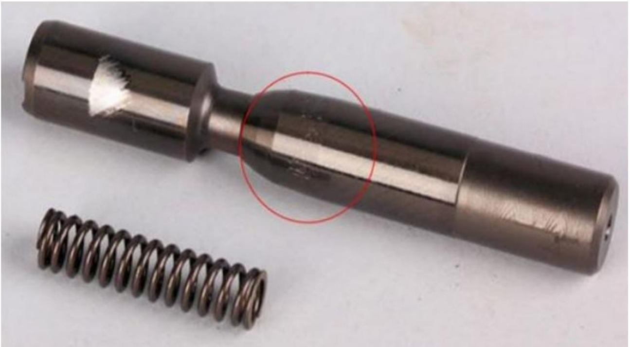
Slika 12. Oštećenja u kliznom dijelu koja rezultiraju blokiranjem ventila
