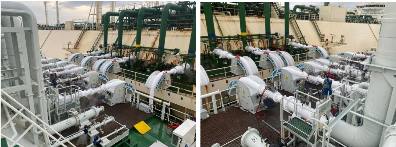
Slika 3 i 3a: Ukrcaj ukapljenog prirodnog plina preko fleksibilnih cijevi – STS (Ship to Ship) operacija
