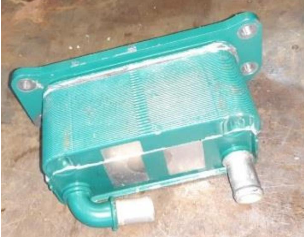
Slika 4: Hladnjak ulja za podmazivanje (pločasti / lamelasti)
