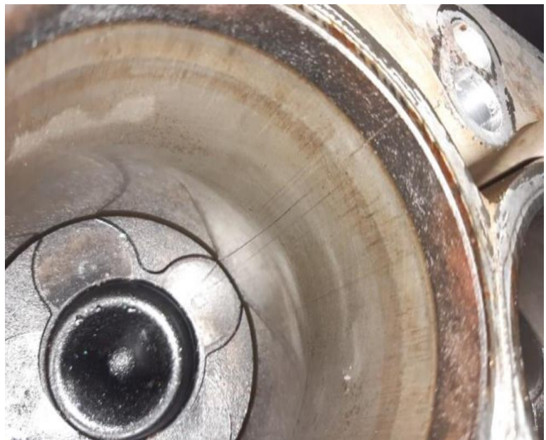
Slika 5: Oštećenja na košuljicama cilindra br. 2 i 3
