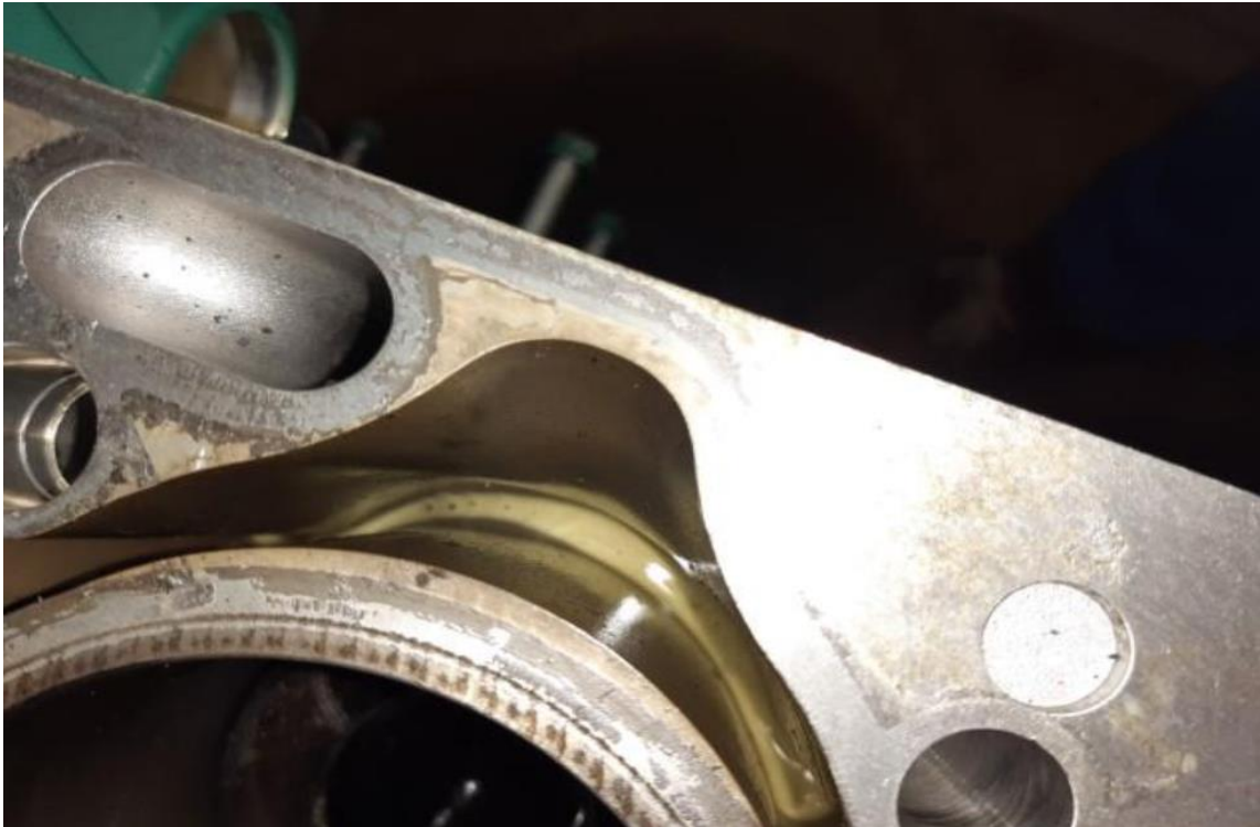
Slika 2: Mješavina ulja i rashladnog medija u rashladnim kanalima bloka motora
