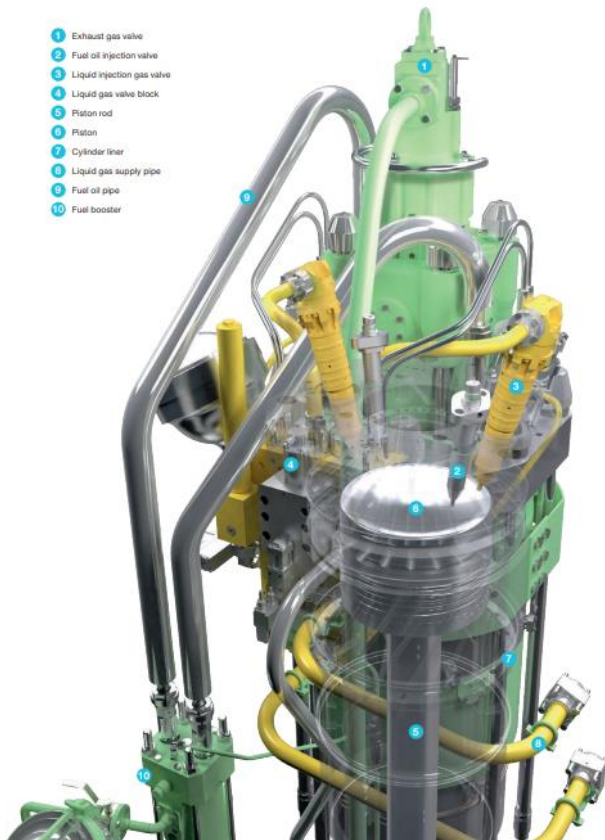
Slika 10. Djelovi motora MAN B&W ME-LGIP
