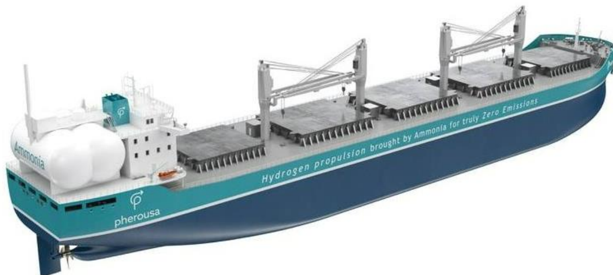
Slika: Pherousa Green Technologies – brod za rasuti teret s glavnom propulzijom na vodik
