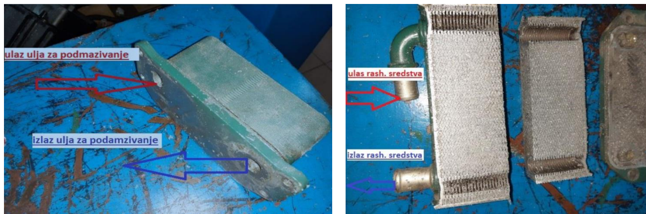
Slike 7 i 8: Otvoreni ("raspilani") hladnjak ulja za podmazivanje
