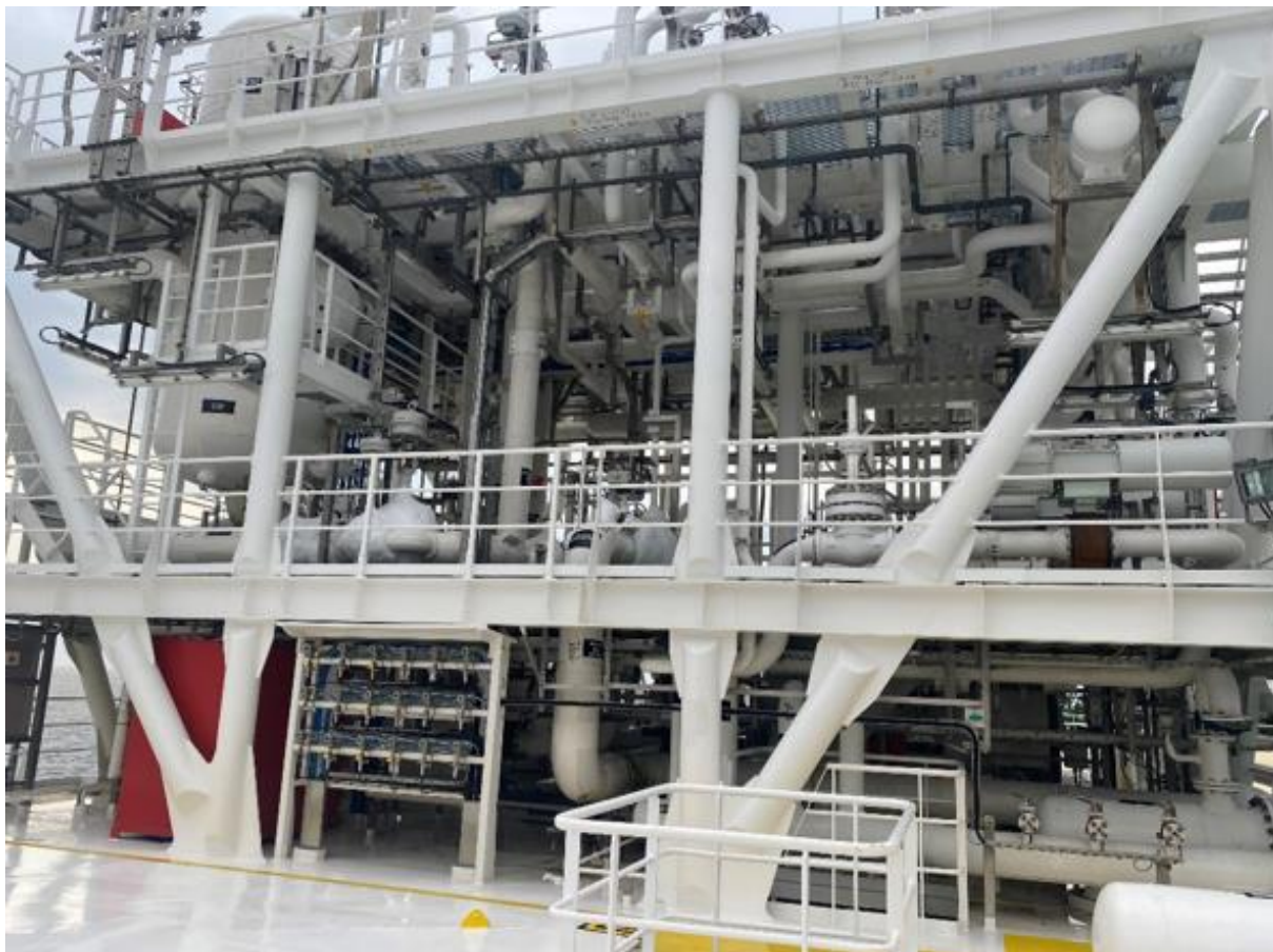
Slika 2: Postrojenje za uplinjavanje, vrlo je kompaktno u cilju što manjeg zauzimanja prostora
