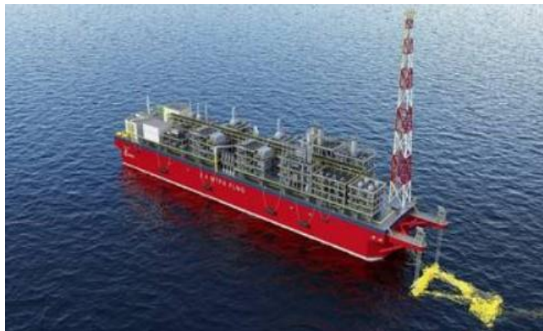
Slika: FLNG - jedinica za proizvodnju, skladištenje i iskrcaj ukapljenog prirodnog plina
