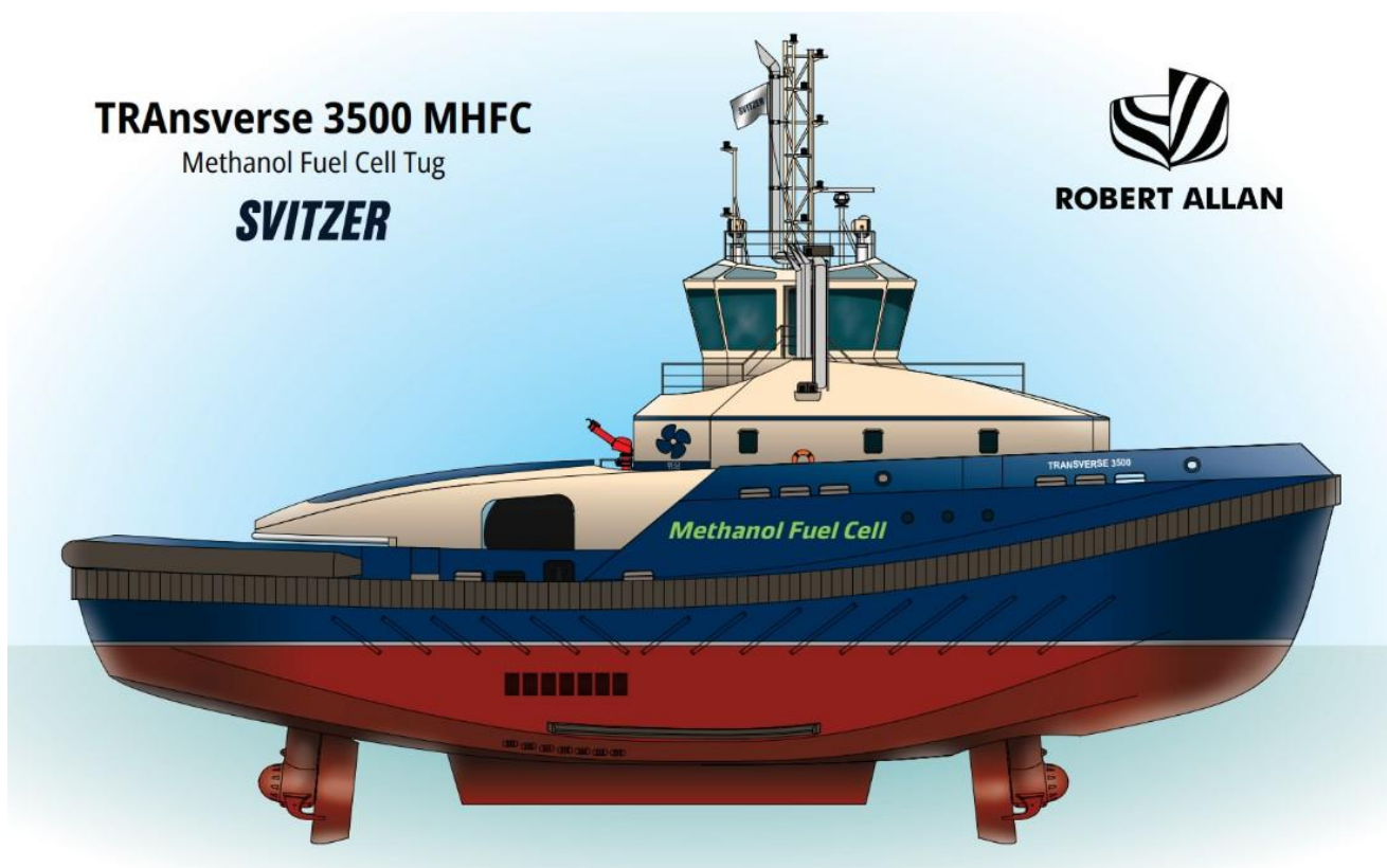
Slika: Svitzer tegljač s hibridnim gorivnim člancima na metanol
