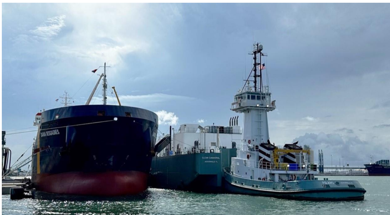
Slika: Bunker ukapljenog prirodnog plina kao goriva s teglenice Clean Canaveral na teretni brod
