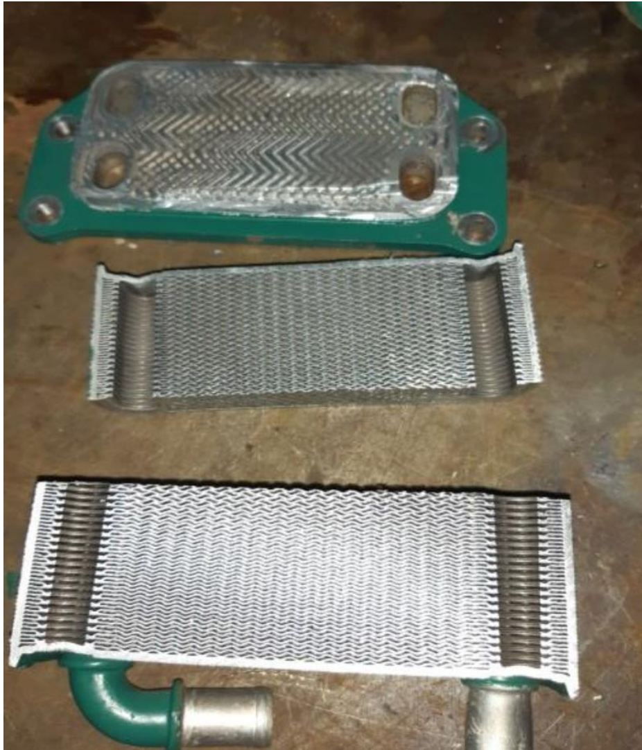
Slika 6: Otvoreni ("raspilani") hladnjak ulja za podmazivanje
