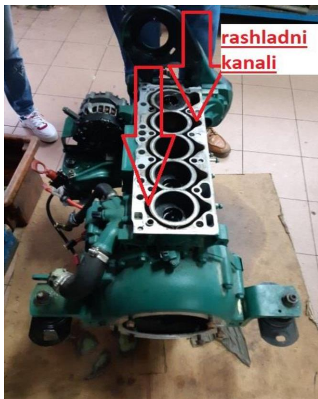
Slika 1: Rashladni kanali pogonskog motora
