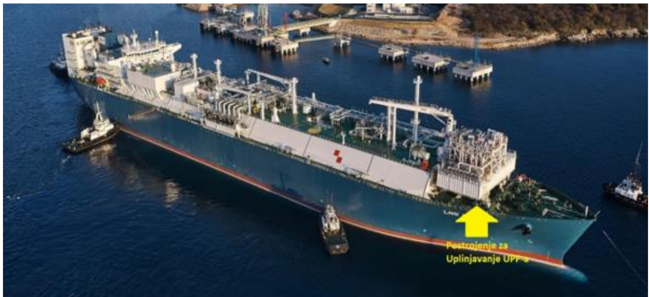
Slika 1: Plovna jedinica s prikazom lokacije postrojenja za uplinjavanje
