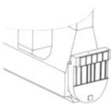
Slika 21 – Generator pogonjen direktno koljenastom osovinom
