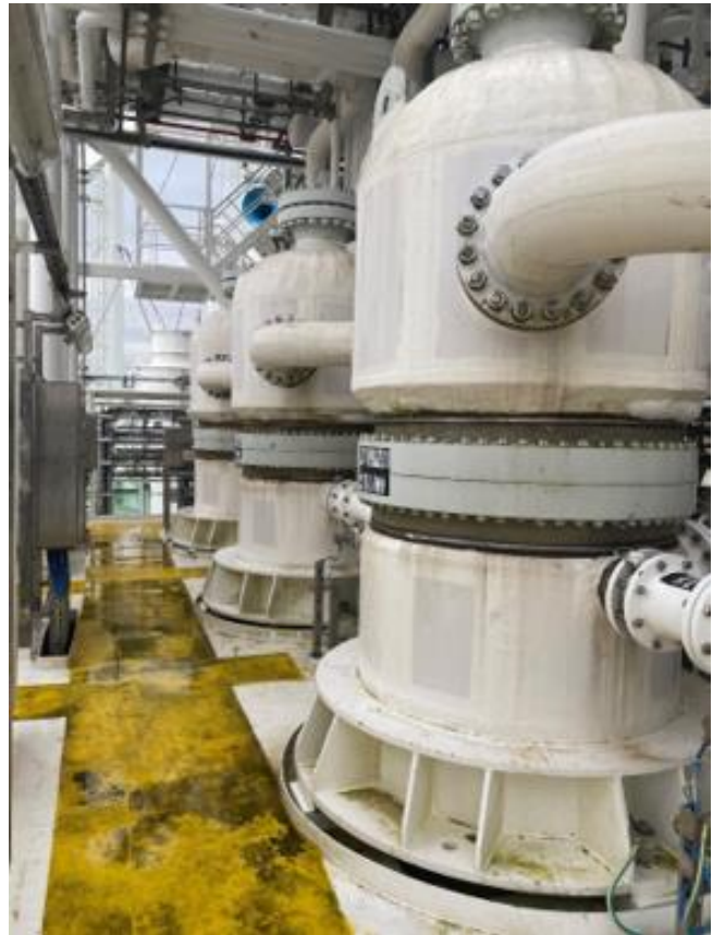
Slika 10a i 10b: Tri glavni isparivač u postrojenju
