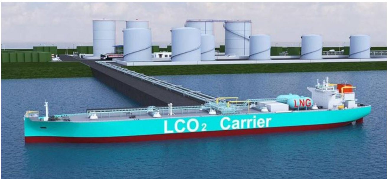
Slika: Iskrcaj ukapljenog CO 2 s broda u kopnene skladišne tankove
