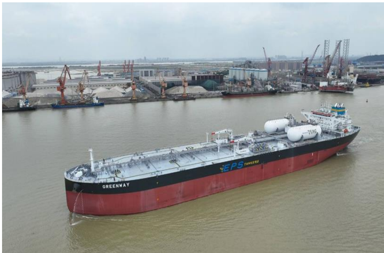
Slika: Greenway od 57000 DWT, LNG Suezmax tanker pogonjen dizel gorivom i prirodnim plinom
