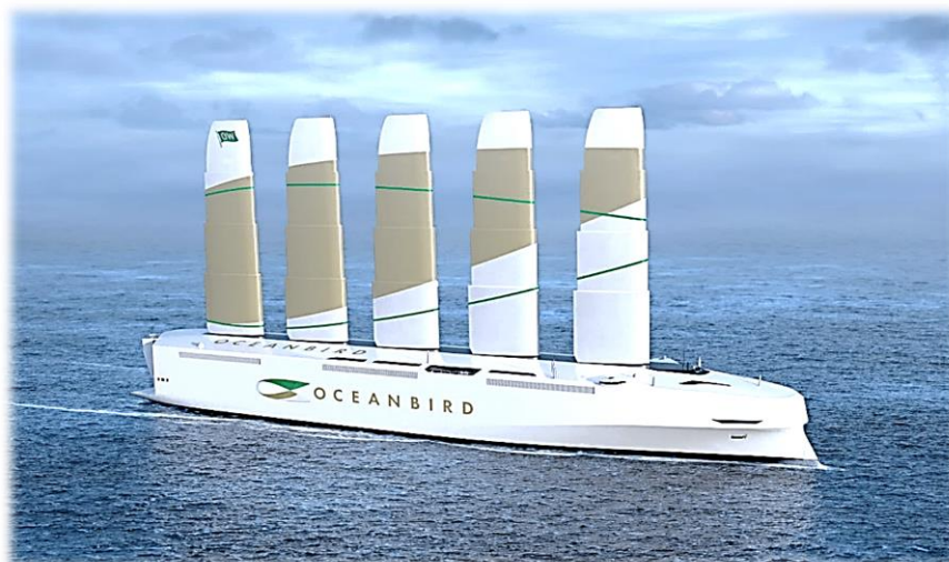
S 80 m visokim metal/kompozit jedrima, snaga vjetra dominira propulzijom broda „OCEANBIRD“
