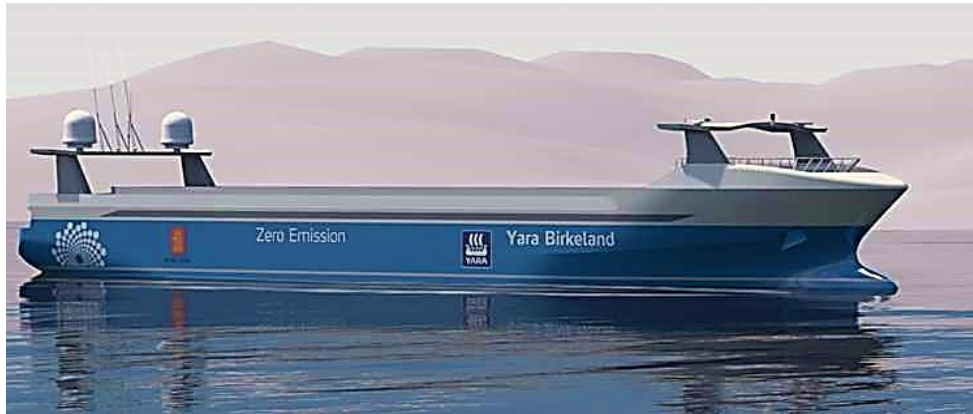
"Yara Birkeland" u autonomnom izdanju, s uklonjenim nadgrađem Image credits: yara.com
