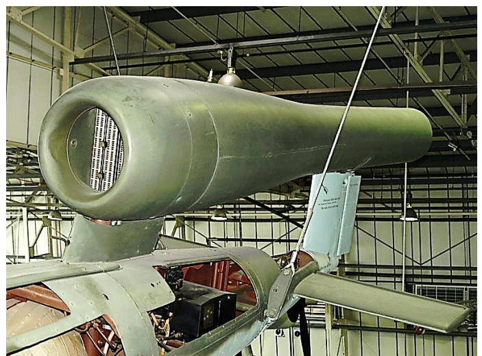
Argus As 014 of the V-1" - leteća bomba izložena u „The Royal Air Force Museum“ - London
