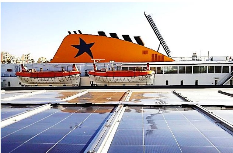
mv ' PANAMANA ' sa solarnim panelima instaliranim na palubi
