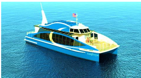
SW/TCH trajekt pogonjen vodikovim gorivnim ćelijama (Photo: Bussines Wire)
