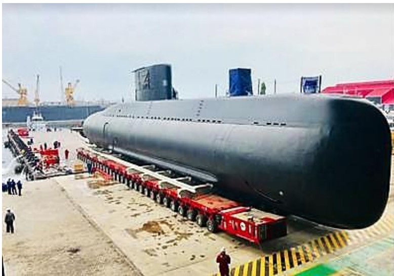
Na slici se vidi crveno obojen SPMT transportni sklop
