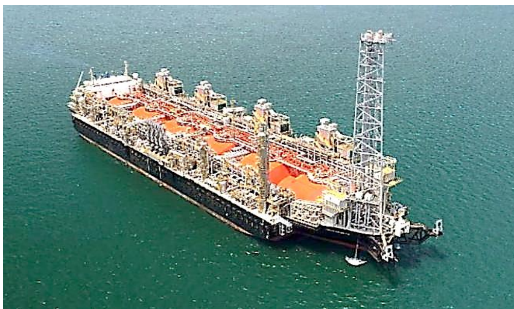
SLIKA 1. Tanker za proizvodnju, skladištenje i ukrcaj prirodnog ukapljenog plina (engl. FPSO - Floating Production Storage and Offloading)
