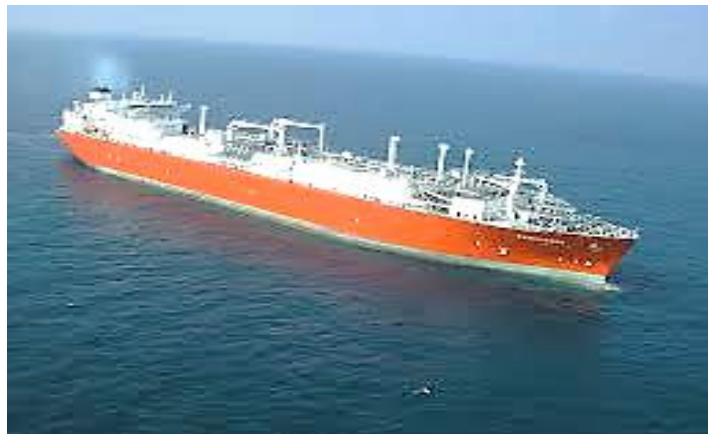
SLIKA 3. Tanker za prijevoz i uplinjavanje prirodnog ukapljenog plina (engl. LNGRV - Liquefied Natural Gas Regasification Vessel)
