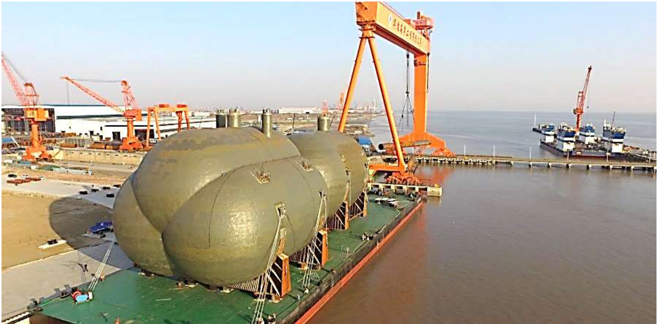
Na ovoj slici vidimo tri-lobe tank za VLEC i jedan cilindrični tank iza njega
