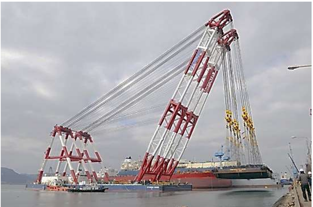
Dizalica Hyundai 10000 testira podizanje teške strukture
