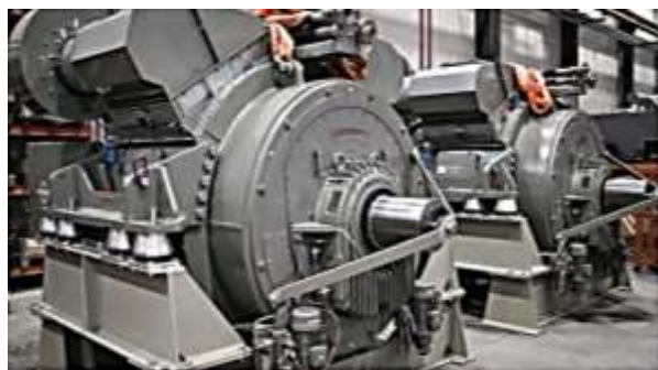
Izravna propulzija; motori s permanentnim magnetima Photo: „the Switch“
