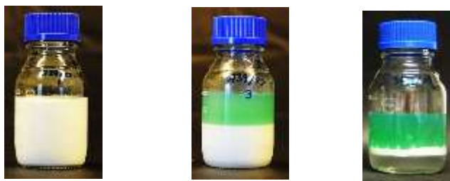
Slika 1. Lijevo – stabilna emulzija, sredina - emulzija sa sedimentacijom, desno – emulzija sa separiranim sastavnicama
