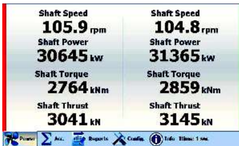
Slika 3: Prikaz veličina na Kyma monitoru obično se sastoji od brzine okretanja broskog vijka, snage na osovini, zakretnog momenta na osovini i potisne sile osovine, Picture Credits Kyma Instruction Manual
