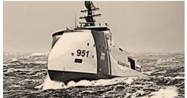
U.S. Coast Guard OPC (Offshore Patrol Cutter) s Ulstein X-bow dizajnom trupa duljine 85 do 130 m dizelelektričnim propulzijskim sustavom
