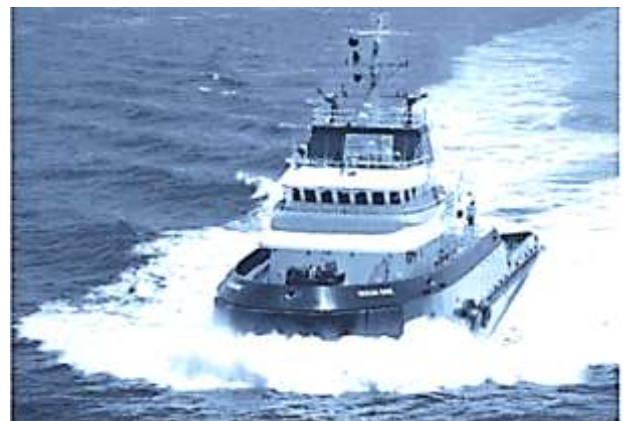
Crowley Maritime Corp. OCEAN WAVE 10.880 KS tegljač oceanske klase s dvostrukom oplatom s DP1 opremom i svom silom naprava za očuvanje okoliša, sposoban za dugotrajno oceansko tegljenje i spašavanje kao i rukovanje sidrima
