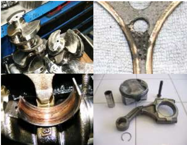
Slika 10 - Uzrok i posljedice hidrauličnog udara
