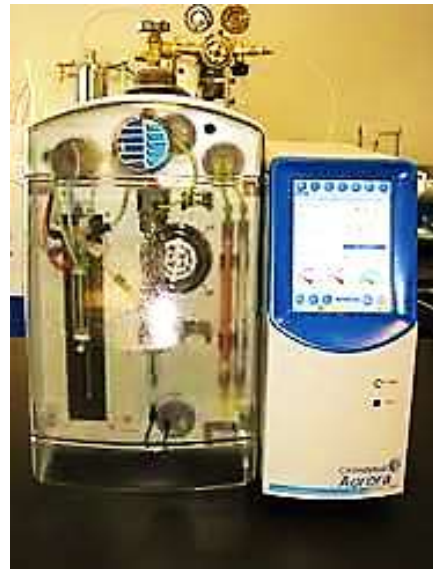
Slika 9 - Detektor ugljika (produkti izgaranja) u rashladnoj tekućini
