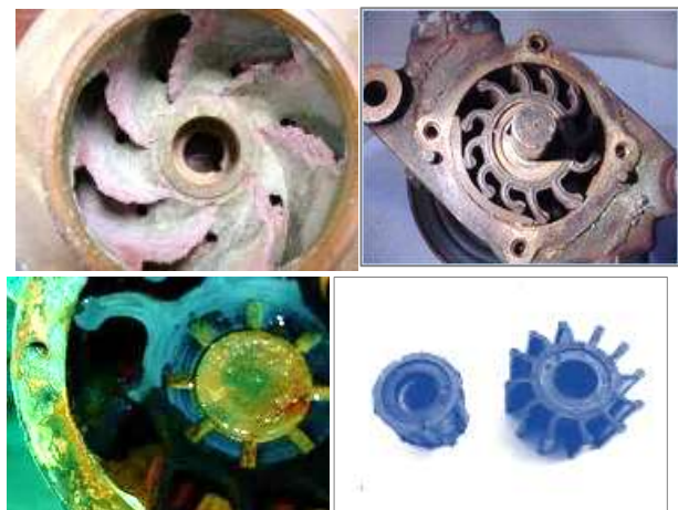
Slika 6 - Primjeri kvarova pumpe morske vode
