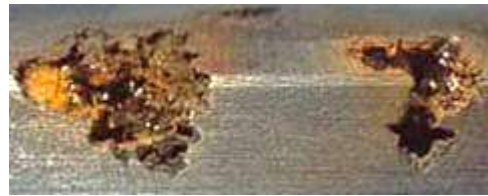
Slika 5 - Erozijske oštećenja na unutarnjoj stijenci cilindara uzrokovana kavitacijom
