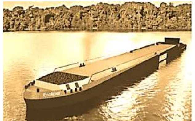
Potpuno novi koncept Damen Shipyards Group i riječne kompanije QaGroup s kombinacijom LNG propulzije i ACES zračno podmazanim trupom broda dugog 110 m sa sveobuhvatnim sustavom upravljanja energijom
