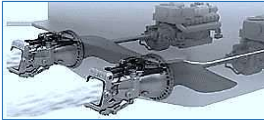
Slika 11 - Vodeno mlazna propulzija Kamewa S3
