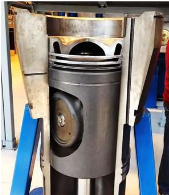
Slika 11 – Presjek klipa i košuljice cilindra
