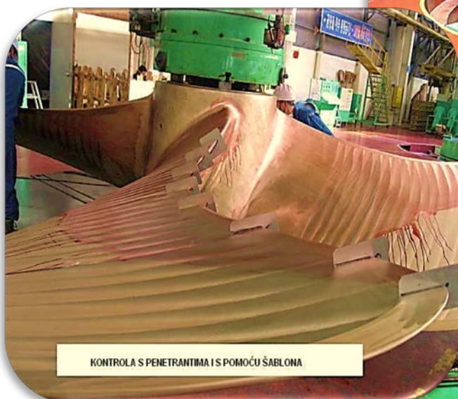
PROPELER NA UREĐAJU ZA STATIČKO BALANSIRANJE
