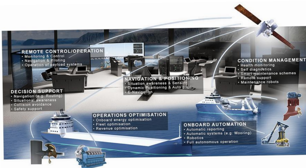
Ova slika ilustrira princip funkcioniranja projekta Rolls Royce AAWA – Photo credit: Inmarsat
