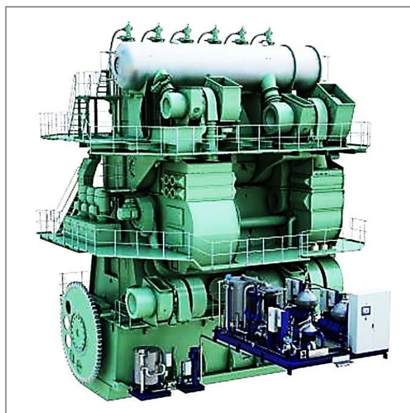
EGR i Alfa Laval PureNOx integrirani na motoru
