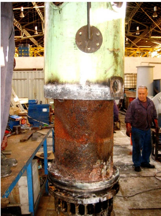
Uz dosta poteškoća plašt je rastavljen od košuljice, Korišteni su kemikalije, grijanje i fizička sila.
