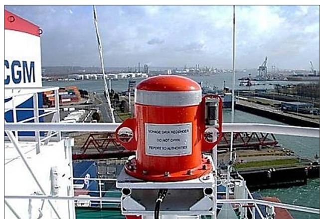
Image Author: Hervé Cozanet Učvršćena podatkovna kapsula VDR-a montirana na nosaču kontejnera
