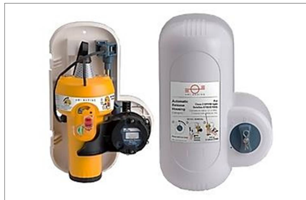
Image Author: Stulish AMI Marine Ltd. „Float Free Capsule“ primjenjuje se na brodovima da zabilježi podatke u trajanju od najmanje 48 sati. Ako brod potone, bijelo kućiše kapsule se otvara i ispušta žutu kapsulu koja će isplutati na površinu da bi alarmirala pomorske vlasti na kopnu i poslala signal za pomoć.
